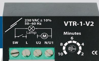
VTR-1-V2 это электронный таймера для вентиляторов, вентиляции небольших помещений, таких как туалетах и ванных комнат. Вентилятор включается 1,5 сек после включения света. Когда свет выключается, вентилятор отключается после установленной задержки времени от 2 до 10 минут.
